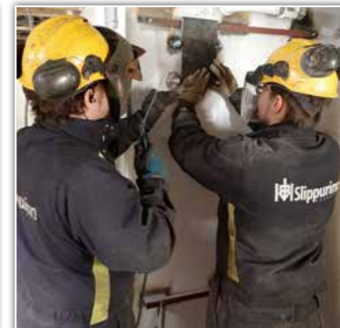
Freyr Þórðarson og Meliej Morewski, stálsmíðir hjá Slippnum, sjóða plötu á vegg um borð í Frosta frá Grenivík.
